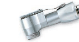
MODELE BB-Y REF. C037 • Pour fraises CA (ø2,35) • Système baïonnette • Maxi. 40 000 t/mn-1
