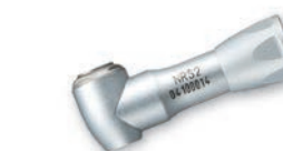
MODELE NRS2-Y REF. C549 • 10:1 Réducteur • Pour fraises CA (ø2,35) • Système Clean Head • Bouton poussoir • Maxi. 40 000 t/mn-1
