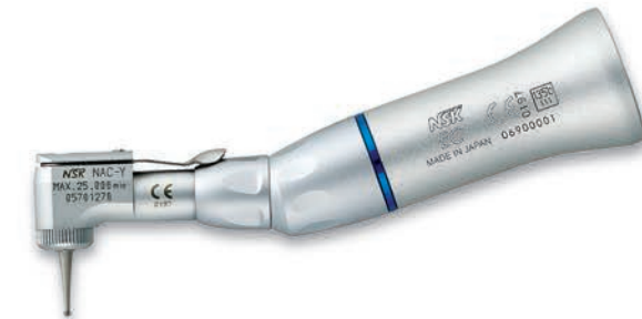
MODELE NAC-EC REF. Y110-148 • Pour fraise CA (ø2,35) • Système baïonnette • Maxi. 25 000 t/mn-1
