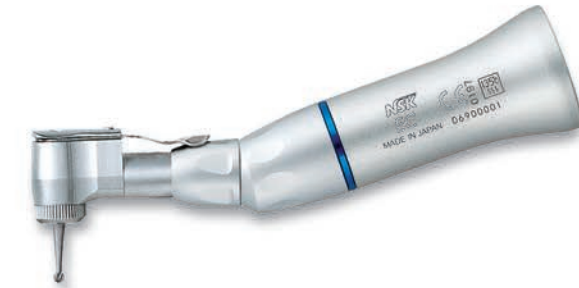
MODELE BB-EC REF. Y110-159 • Pour fraise CA (ø2,35) • Système baïonnette • Maxi. 40 000 t/mn-1
